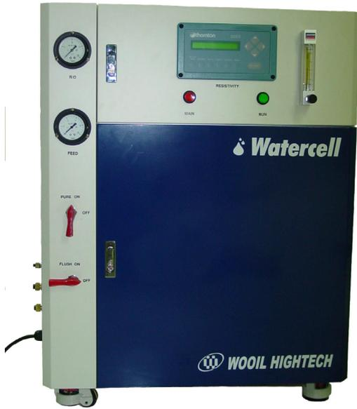
**Watercell**은 역삼투압의 원리를 이용하여 물 속의 불순물을 완벽하게 제거합니다. R/O로 전처리된 물은 이온교환수지 및 Filter Module을 통과하면서 금속이온, 유기화합물, 박테리아, Particle이 제거되어 초순수가 됩니다. 적용분야에 따라서 UV Lamp나 UF의 설치도 가능합니다.
